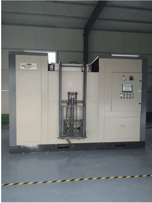
緑華オリジナル廃棄物処理システム (1)低温熱分解処理装置
